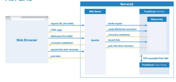
Grafische Darstellung des prinzipiellen Aufbaus der Kommunikationsstrecke zwischen PrepMaster Core/Entry, PrepMaster Remote und den Web-Clients.
