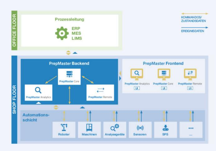
Prinzipielle Darstellung der Struktur von PrepMaster-Systemen. Die Komponenten des Field- und Control-Levels sind mit den Backends der jeweiligen PrepMaster-Module auf dem Supervisory-Level verbunden. Jedes PrepMaster-Modul weist in seinem Frontend ein spezifisches User Interface (UI) auf, welches optimal an die spezifischen Aufgabenstellungen angepasst ist.
