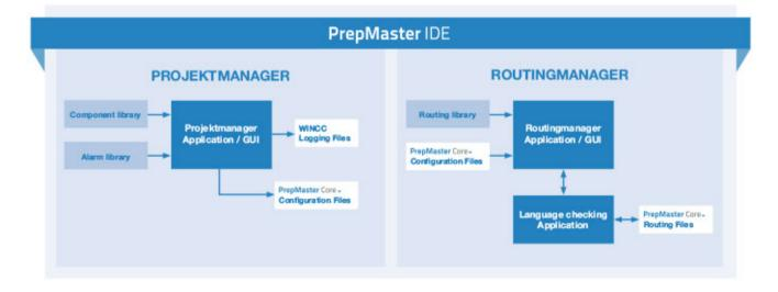
Grafische Darstellung des prinzipiellen Aufbaus der PrepMaster IDE: Im Projektmanager werden alle Konfigurations-Dateien zusammengestellt. Im Routingmanager erfolgt die Programmierung des Ablaufs der Proben durch die Anlage.
