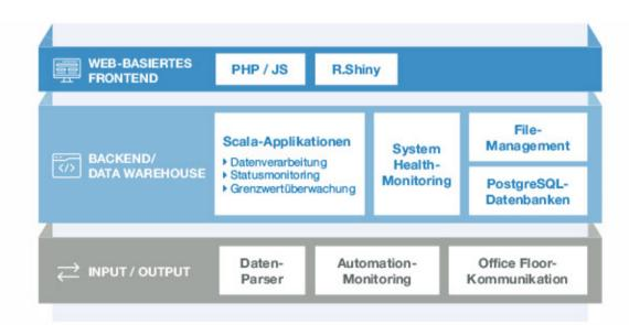
Dreischichtiger Aufbau der PrepMaster Analytics-Software mit web-basiertem Frontend, Backend und Data Warehouse sowie der Input/Output-Schicht zur Datenaufnahme und -weiterleitung.
