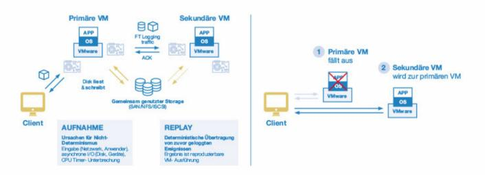
Grafische Darstellung des prinzipiellen Aufbaus des Fault Tolerance-Systems von PrepMaster Core. Das System ist in der Lage, den Ausfall einer oder mehrerer Komponenten zu kompensieren und einen ununterbrochenen Dienst zu gewährleisten.
